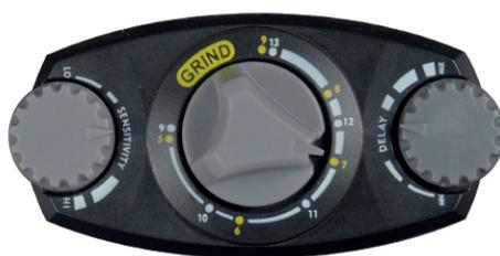
V režimu broušení GRIND je funkce tmavnutí vypnutá. Během této doby má LCD průzor nejsvětlejší stav, což pomáhá získat jasnější pohled vedle maximální ochrany. Při použití režimu broušení bude blikat kontrolka „GRIND FLASH“ na horním okraji vnitřní strany LCD kazety.
