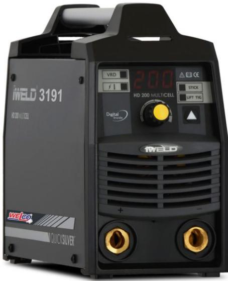
**WELCO IWELD 3191** je malý výkonný multifunkční svařovací invertor pro svařování obalenou elektrodou a TIGem s dotykovým zapalováním. Stroj je postaven na technologii IGBT, která oproti starším technologiím má menší ztrátový výkon, což umožňuje používat menší chladiče a tím také vyrábět menší, výkonnější a ekonomičtější svařovací zdroje.
